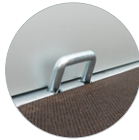
8 Bindehaken an der Innenseite der Ladefläche
