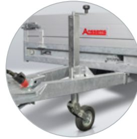
Lange Deichsel mit klappbarem Stützrad
