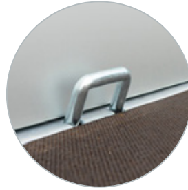
8 Bindehaken an der Innenseite der Ladefläche
