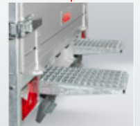
Auffahrschienen, die unter dem Ladeboden aufbewahrt werden.
