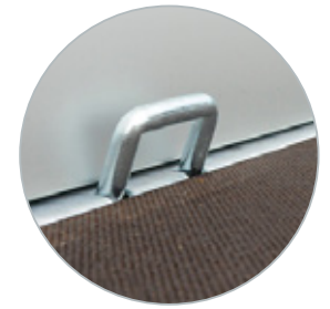
8 Bindehaken an der Innenseite der Ladeplattform
