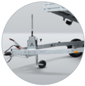
Deichselprofile führen bis zur Rückseite der Ladeplattform
